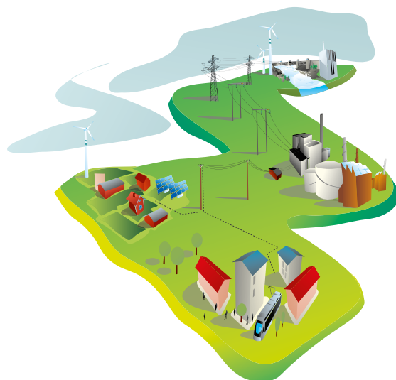
Bild 5 - Syftet med ett elsystem är att överföra elektricitet från producent till konsument. Det består av luft- eller markledningar av olika spänningsnivåer och utföranden.
