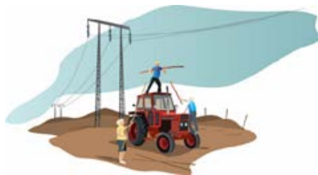
Bild 31 - Parkera inte fordon inom ledningens försiktighetszon.
