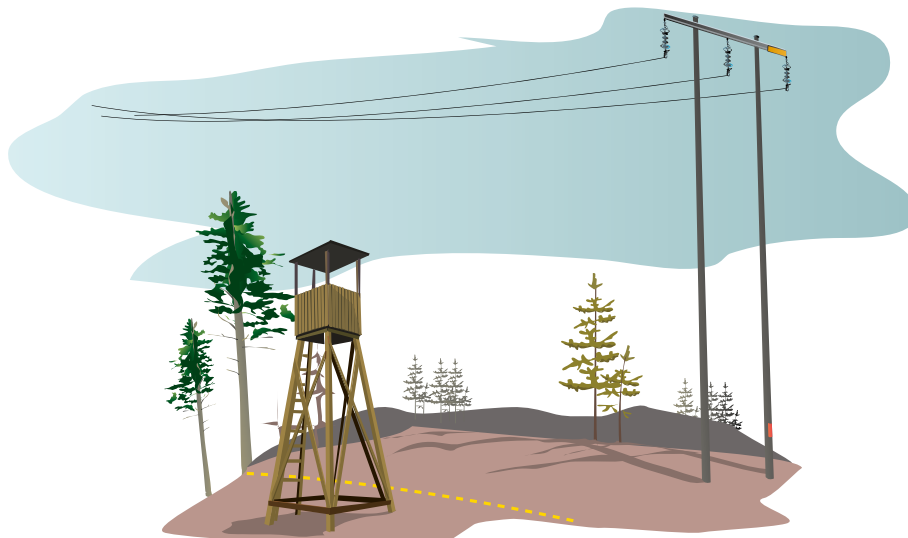
Bild 37 - Jaktorn bör inte placeras inom luftledningens försiktighetszon, även om sikten för jakt anses bättre inom det här området. Samråd med elnätsföretaget om jaktornet placeras strax utanför försiktighetszonen, då höjden på jaktornet kan innebära en risk.
