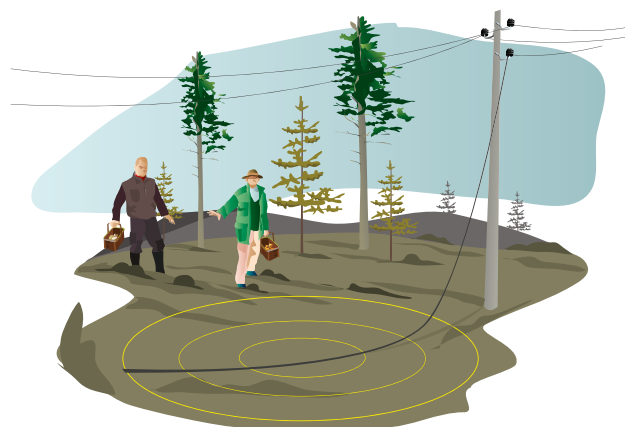
Bild 3 - En luftledning som fallit till marken, en avgrävd eller skadad kabel, kan vara direkt livsfarlig. Kontakta alltid 112 och håll ett avstånd till platsen.
