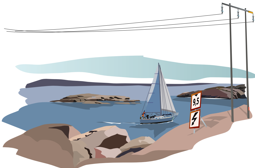
Bild 32 - Risken att komma åt luftledningar kan finnas om man framför fartyg under luftledningar.
